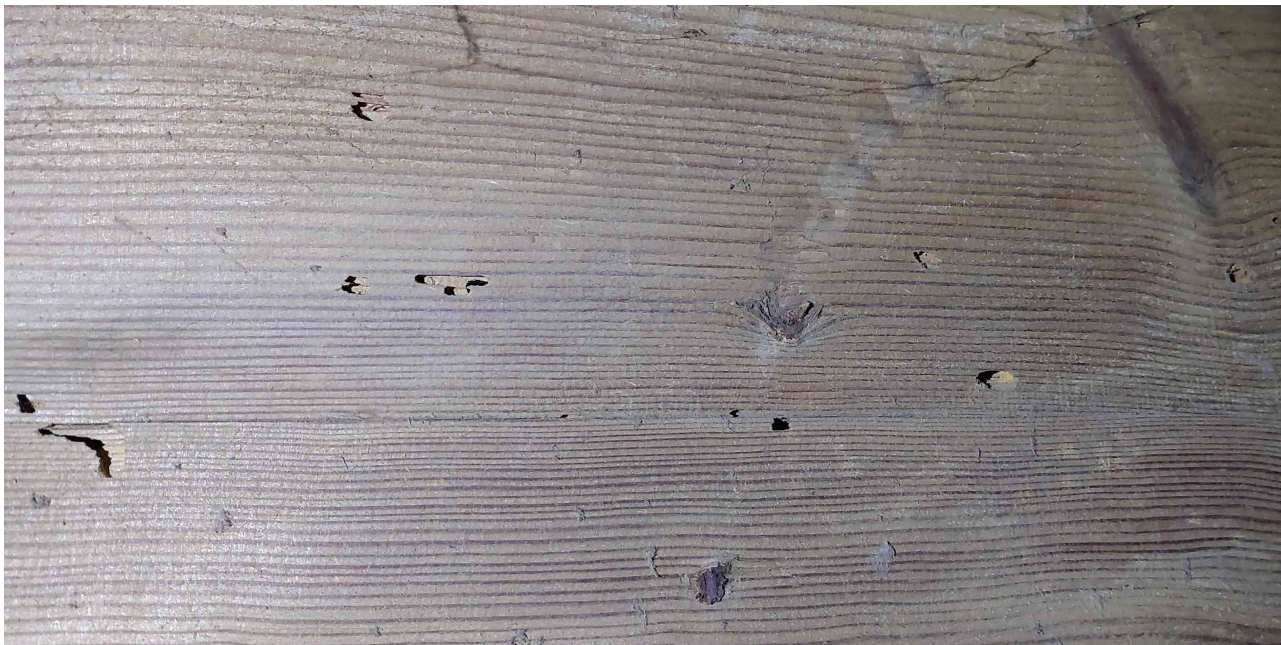
Obr. 23: výletové otvory po tesaříkovi
